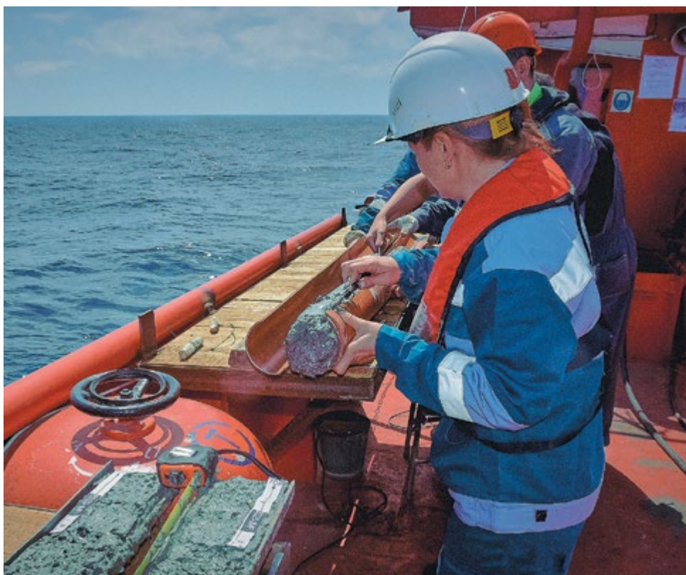
Геотехнические исследования. Извлечение керна из керноприемной трубы
