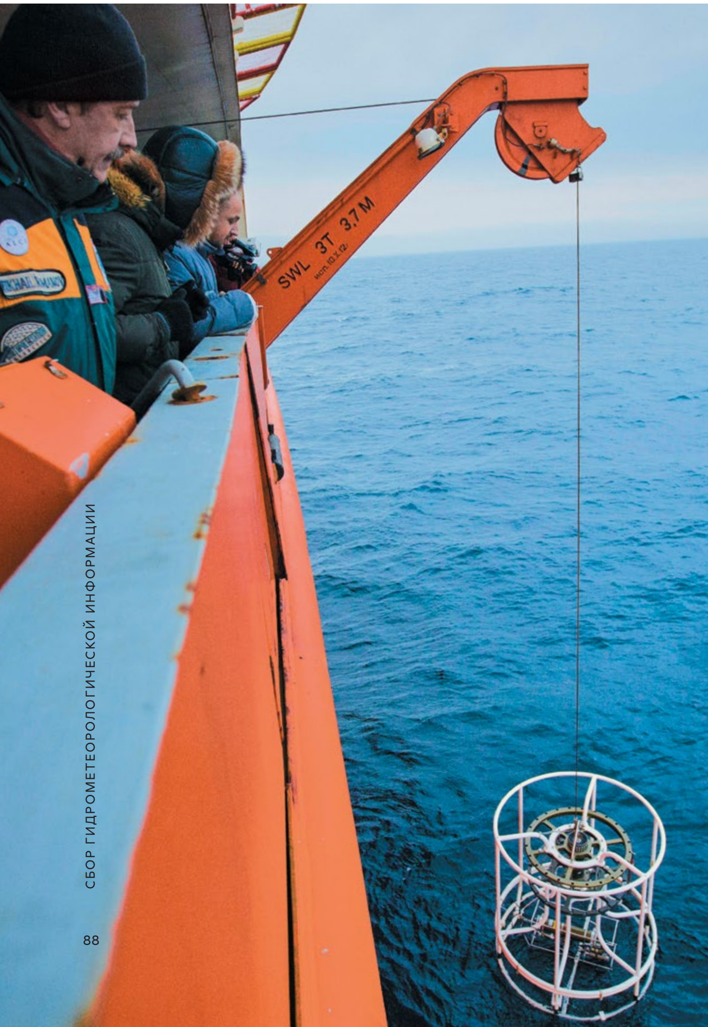
Изучение термохалинной структуры, спуск зонда «Розетта» с батометром
