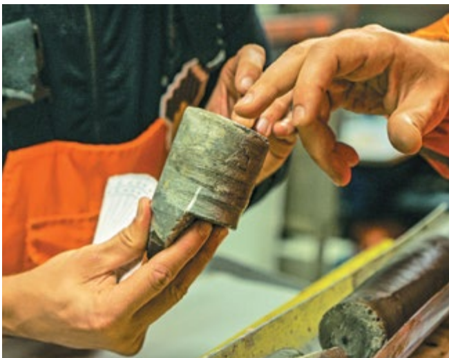
Экспресс-анализ керна стратиграфической скважины на борту судна «Бавенит»
